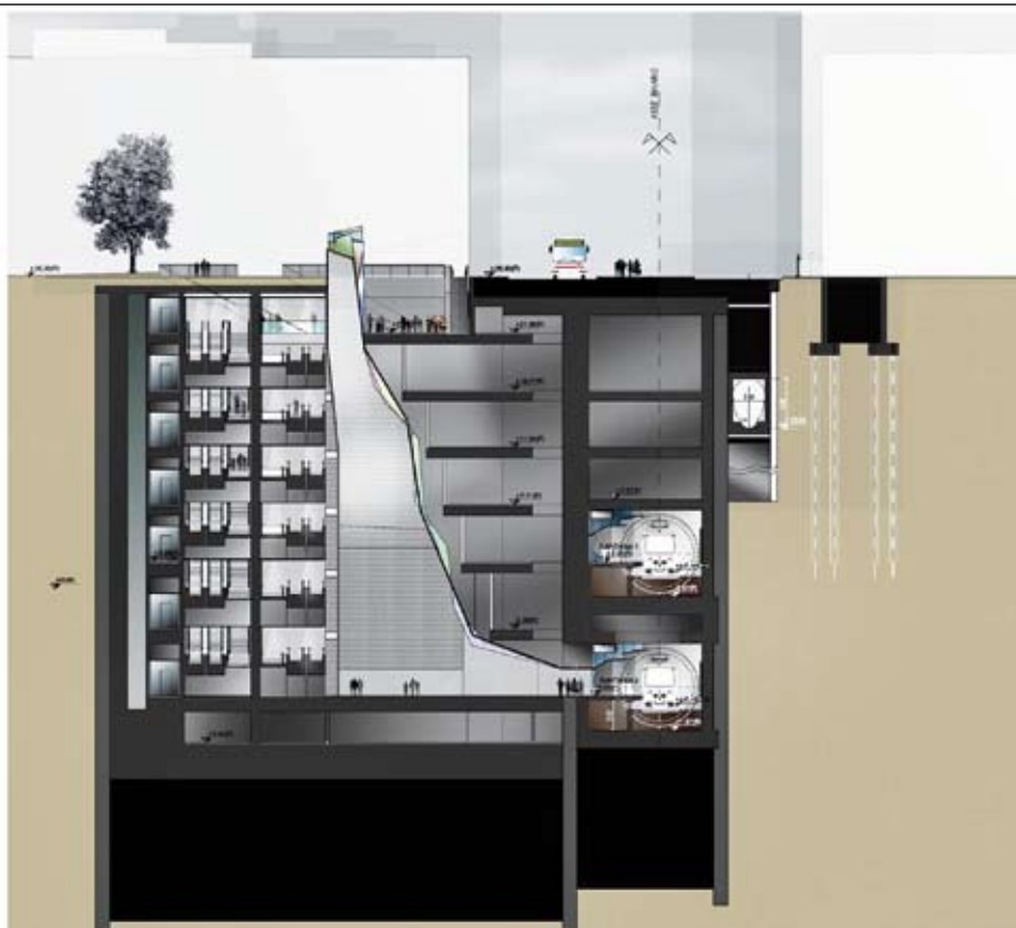
Figura 10 – Stazione Libia/Gondar – sezione architettonica
